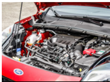
Ford Puma 1.0 EcoBoost Hybrid Der Vierzylinder-Otto stellt 155 PS und 240 Nm bereit.
